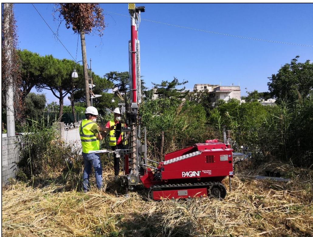
Figura 2b – Penetrometro Pagani utilizzato per le prove penetrometriche dinamiche.
